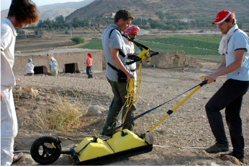
جهاز المسح الجيوفيزيائي باستخدام الموجات الرادارية في تل الحمة
