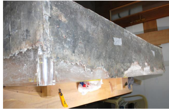
الشكل 7: تجريح القميص الداخلي للبلاستيك الزجاجي بالمشروط لصب الشمع في الأجزاء الناقصة.
